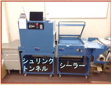
「シュリンクトンネル」と「シーラー」の2つの機械を使って包装します。
