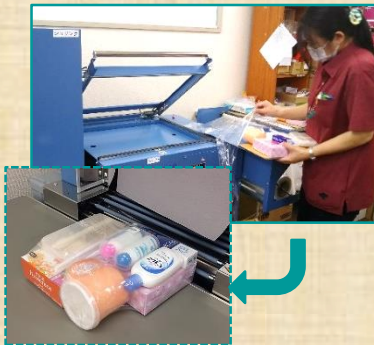
④シュリンクのコンベアへ流します
