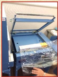
①シーラーにて商品にフィルムをかぶせる
